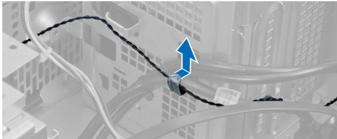
5. Premere le linguette da entrambi i lati per sbloccare e rimuovere il sensore termico dal telaio.
