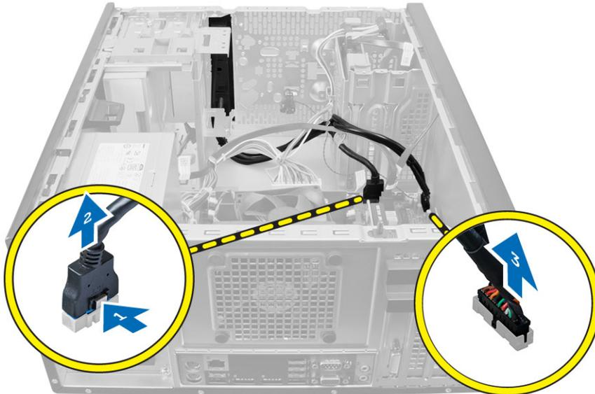
4. Sfilare e sbloccare il cavo del pannello di I/O, il cavo dati e il cavo dati USB dal fermaglio sul computer.
